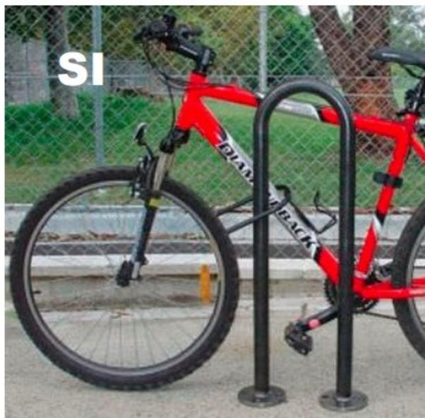
Il supporto deve permettere di assicurare, tramite catena o lucchetto, il telaio della bicicletta ad un sostegno stabile
